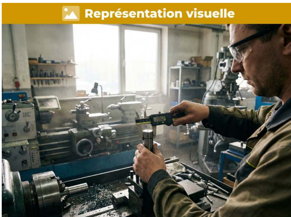
Mesurer avec un pied à coulisse pour des tolérances de \pm 0,01 mm
